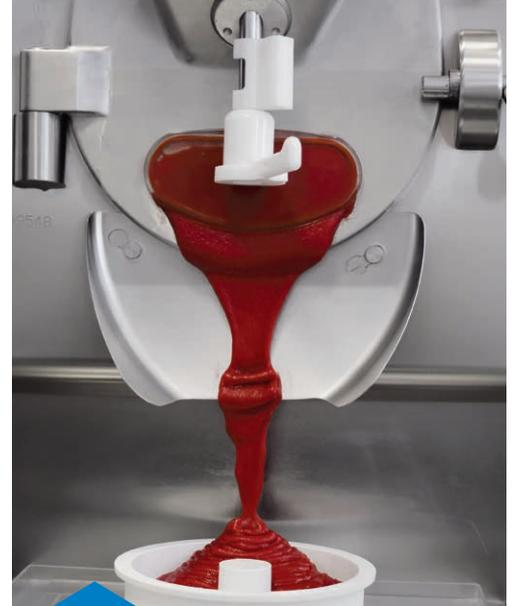
Grace à l'**entretoise**, pouvant être montée à n'importe quel moment, il est possible de réduire l'ouverture de la porte, facilitant l'extraction du produit Crystal et le nettoyage de la machine.
