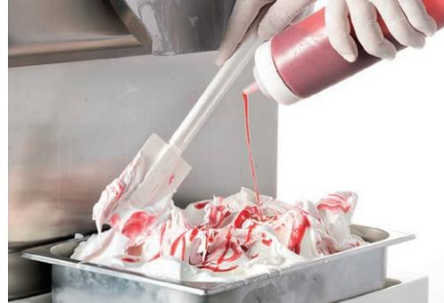
Grâce à l'inverter (variateur de fréquence), il est possible de **marbrer la glace** dans son bac sans arrêter la turbine ni fermer le portillon : la vitesse de l'agitateur peut être réduite jusqu'à interruption complète de l'extraction de la glace, facilitant la distribution des topping. En augmentant la vitesse de l'agitateur, la sortie de la glace reprend.
